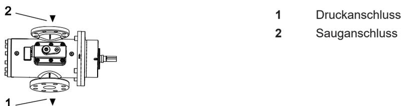
Abb. 8: Durchflussrichtung
