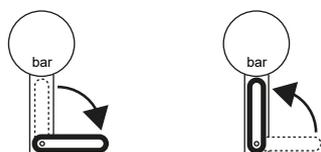
Abb. 10: Manometerabsperrentil geschlossen/offen - Prinzipbild
